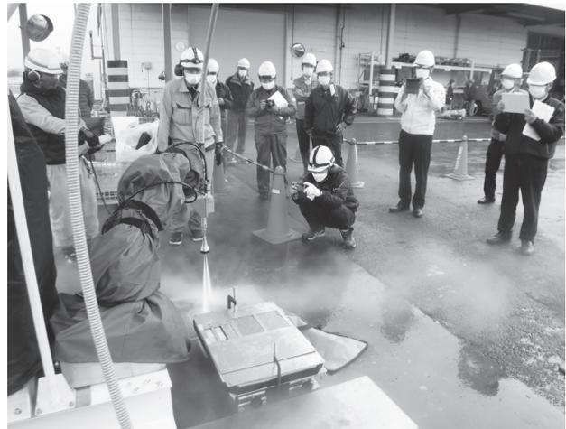
試験体に対して通常使用される圧力に設定し、スタンドオフを変えて噴射した。
